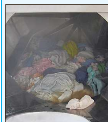
Ein Blick in die Trommel der zehn Meter langen Waschstraße.
